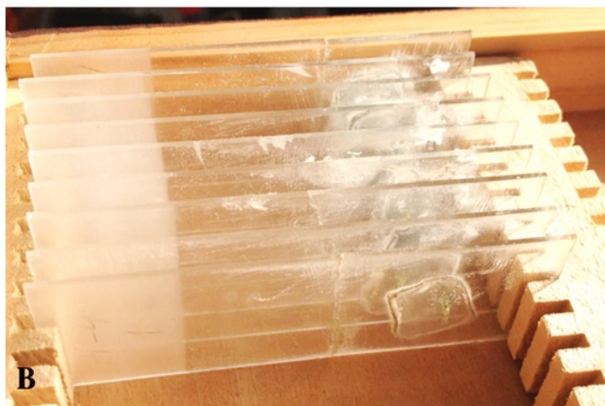
Рисунок 5 - Этапы приготовления шлифов. а - Образец свода черепа, заключённый в блок полиэтилметакрилата. б - Нарезка материала на самодельном отрезном станке. в - Серия шлифов, полученных из образца теменных костей крысы.
